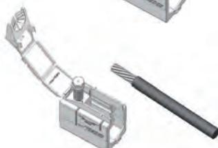
2°) Déplacement de la coulisse **imperdable** de la borne vers le haut afin de permettre une prise du conducteur par devant.
